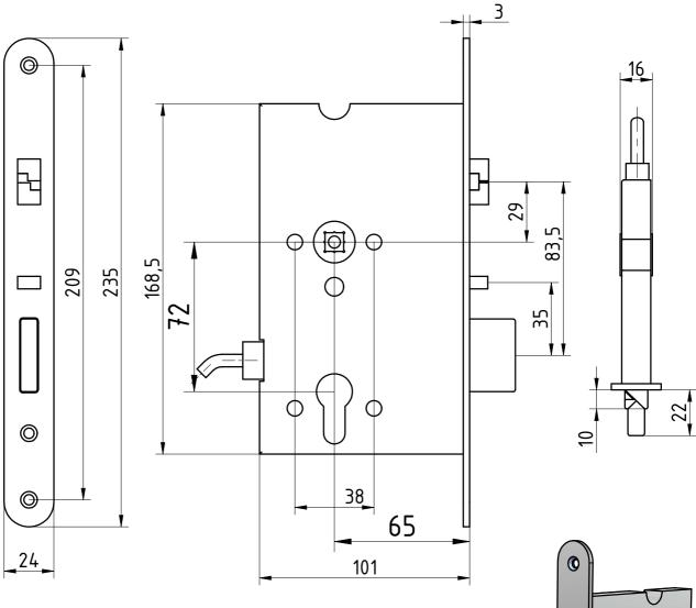
serrure ABLOY EL560 – contrôle d'accès d'un côté serrure ABLOY EL561 – contrôle d'accès de deux côtés
